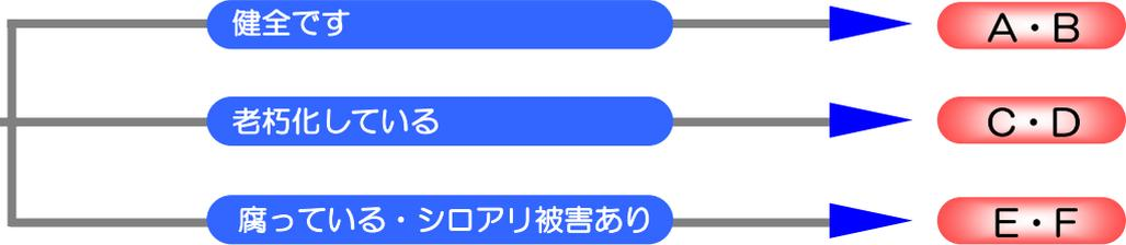
例え強い建物でも、一部の柱や梁が腐っていたりシロアリの被害があれば、地震時に倒壊する危険性があります。
