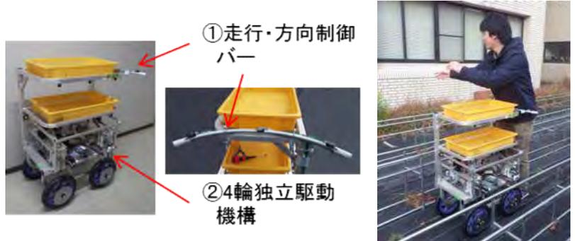
手を使わずに走行・方向制御が可能で、ハウス内で容易に展開できる作業台車の開発
