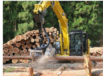
高性能林業機械による造材作業の効率化(十津川村)
