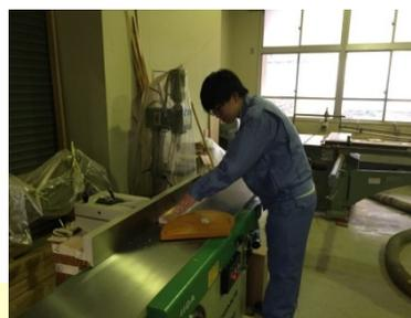
長押（なげし）材をつくるために材料の反りを手押しかな盤で削り取っている生徒
