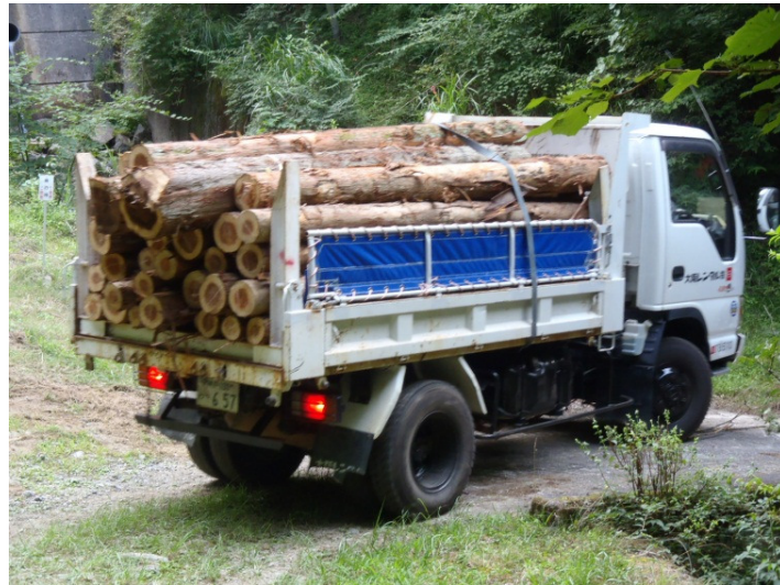
H25 小型トラック(3t積み)運送 幅員の狭い作業道でも作業可能
