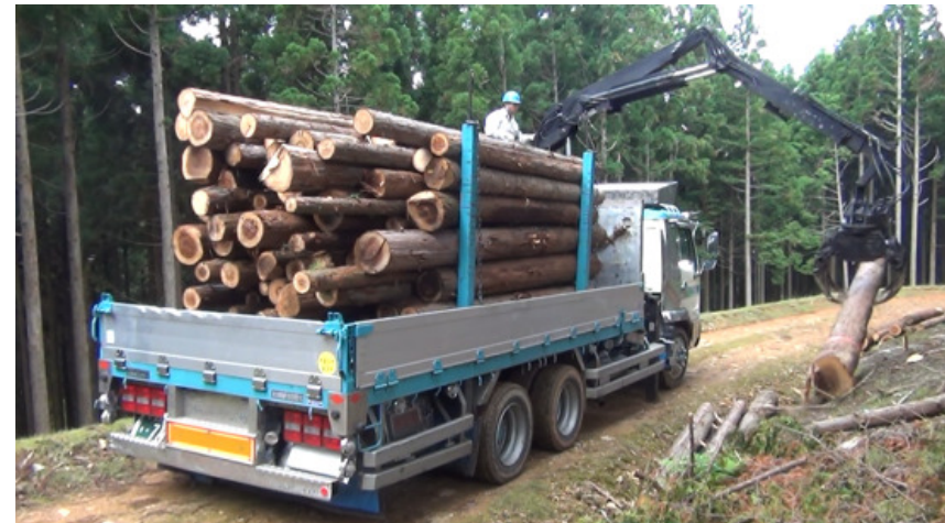
H26 汎用のグラップル付きトラック(10t積み) による積み込みは幅員の広い林道のみ作業可能
