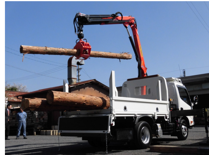
H27年3月導入 奈良型林業機械(2.55t積み) 奈良県の狭い作業道(幅2.5m)にも対応できる林業機械 として、H27年度に搬出実験予定
