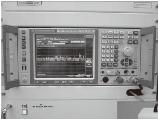
EMC測定・対策材料評価システム
