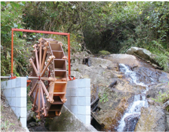
地域の人々が共同で製作した小水力発電のための木製水車(山添村)
