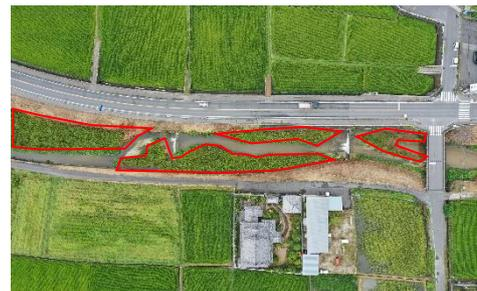
写真 5-1 堆積土砂のみ着色(葛城川)
