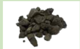
RC-40 (コンクリート塊・アスファルト塊)
