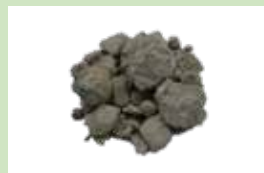
RC-40 (コンクリート塊・アスファルト塊)
