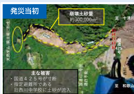
▲台風12号により、大規模な土石流が発生。 (写真:吉野郡十津川村 大畑瀬 2011年)
