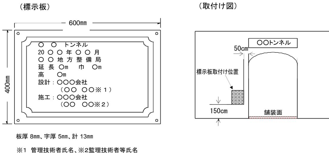
図 6-7-2 標示板の設置イメージ図
