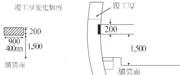
図 6-7-1 覆工厚変化箇所の刻示標準図
