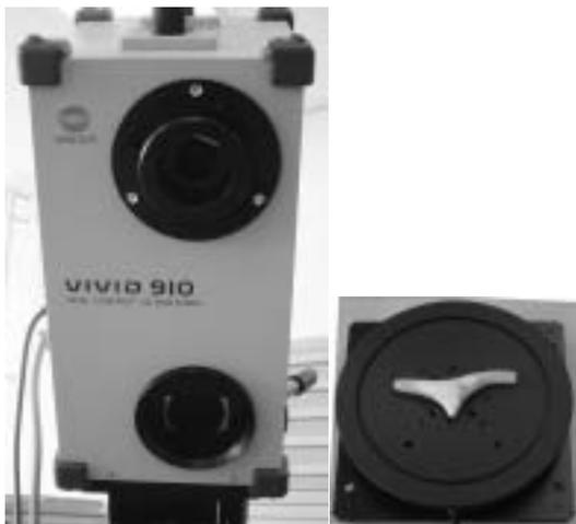
図3. 非接触3次元形状入力装置
