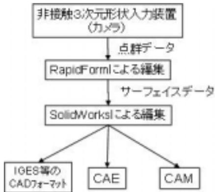
図2. 3次元形状データ処理の流れ
