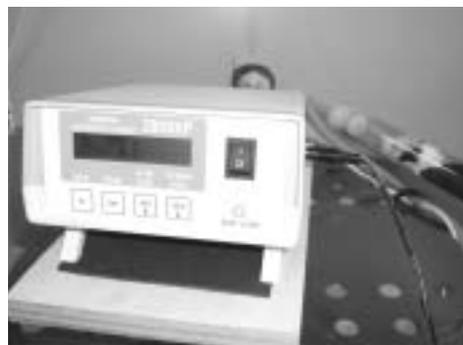
空気中のアンモニア濃度を測定する方法として、対象空気をアンモニアガス用検知管つき吸引ポンプで引き、検知管の変色域でその濃度を読み取る検知管法が一般的です。この方法は簡単ですが、長時間にわたる連続測定や短時間での濃度変化を測定することには適していません。今回導入した測定器は、濃度範囲が0.1ppm~50ppm、解像度が0.1ppm、そしてLEDディスプレイに10秒毎の濃度(ppm)を表示させることができます。また、データロガーが内蔵されているため、測定記録をコンピューターに表示させ、データ解析も可能です。
