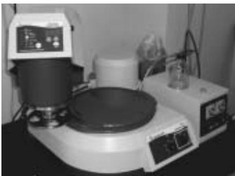
セラミック材料や金属材料などの硬質材料の組織観察や物性試験に必要な鏡面加工を行う装置です。加工可能な最大試料寸法は、直径約20mm、高さ約10mmで、あらかじめ樹脂埋めしておく必要があります。
