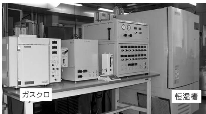
ガス透過率測定装置全景
