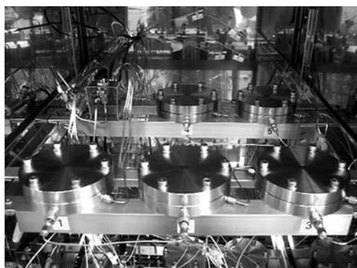
恒温槽内フィルム測定用セル
