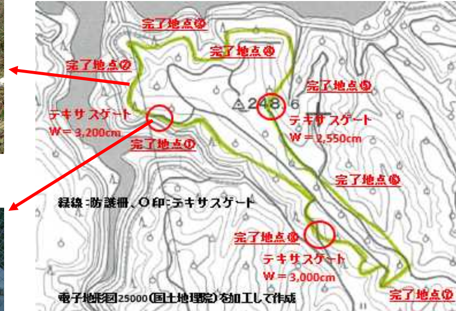
共同作業による防護柵(ワイヤーメッシュ柵)の設置
