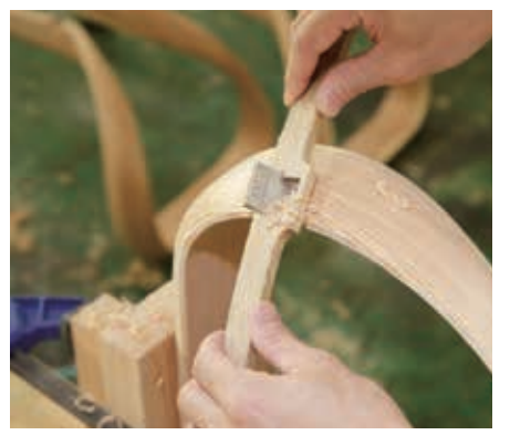
▲重ねた板を時間をかけて曲げ成形し、鈎で美しく仕上げている
