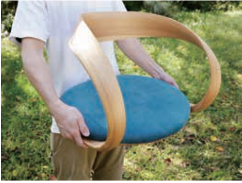
▲重ねた板を時間をかけて曲げ成形し、鈎で美しく仕上げている
