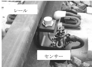
図3 センサーの設置状況
