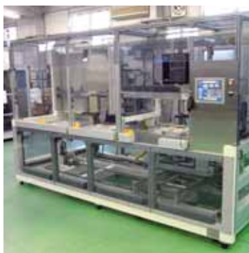
ガラス貼合せ装置。パネルとの間に気泡や異物を混入させません。
