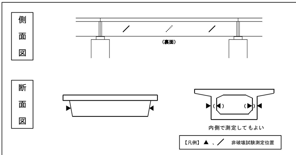
図3 橋梁上部工の測定位置 (例)
