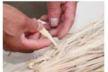
楮を蒸し、剥ぎ取った樹皮を山や川のきれいな水に晒して、白い状態に。
