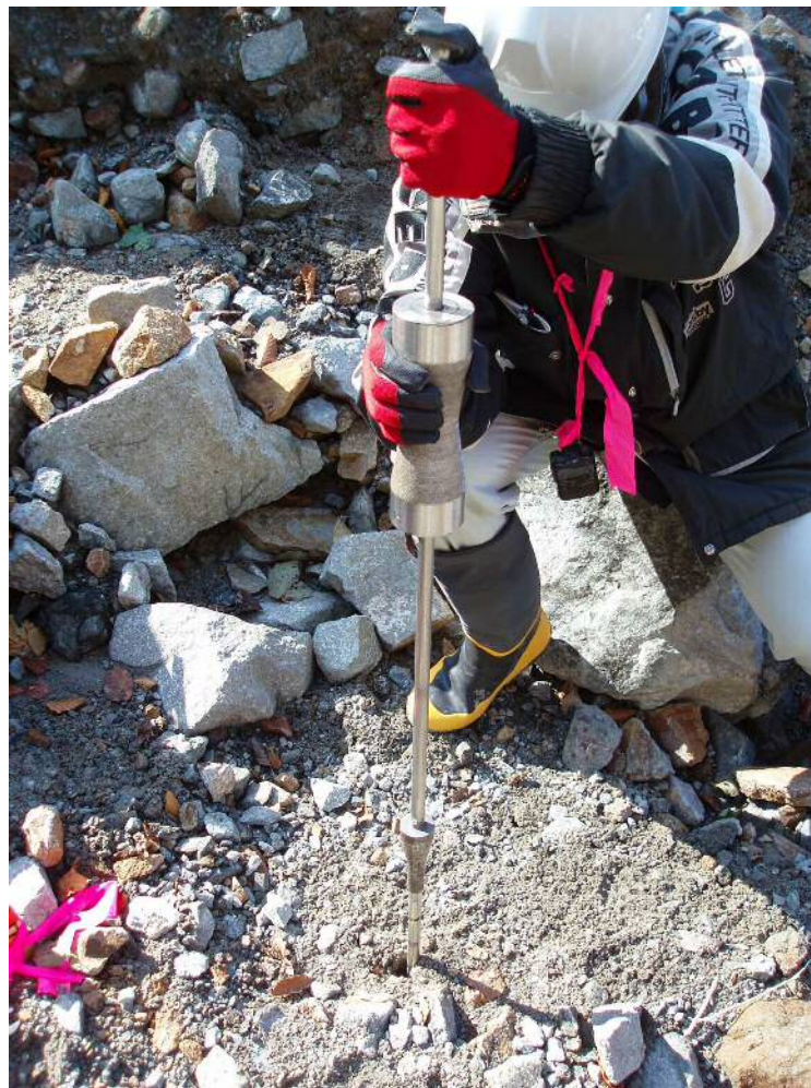
斜面調査用簡易貫入試験器
