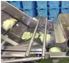
電解水を使い、流水で洗浄殺菌
