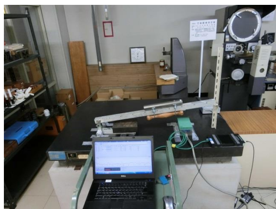
図 3 落下試験状況
