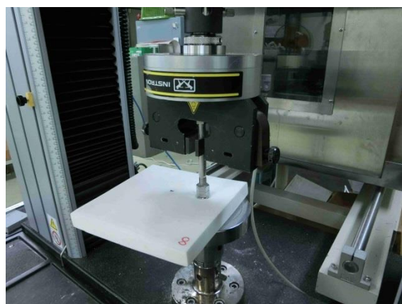
図 4 残留へこみ試験状況
