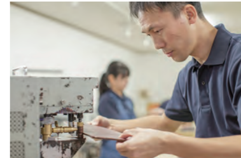
革の断面にニスを塗る工程「コバ塗り」
