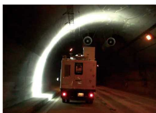
レーザースキャンによる変状把握(ひび割れ、うきの確認)
