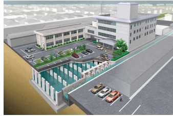
▲【工事中】地下貯留施設(大和高田市)
