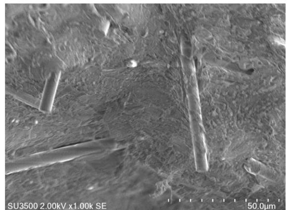
図 7 熱処理炭素繊維および相容化剤を混練した容器リサイクル樹脂片の破断面 (1000 倍)
