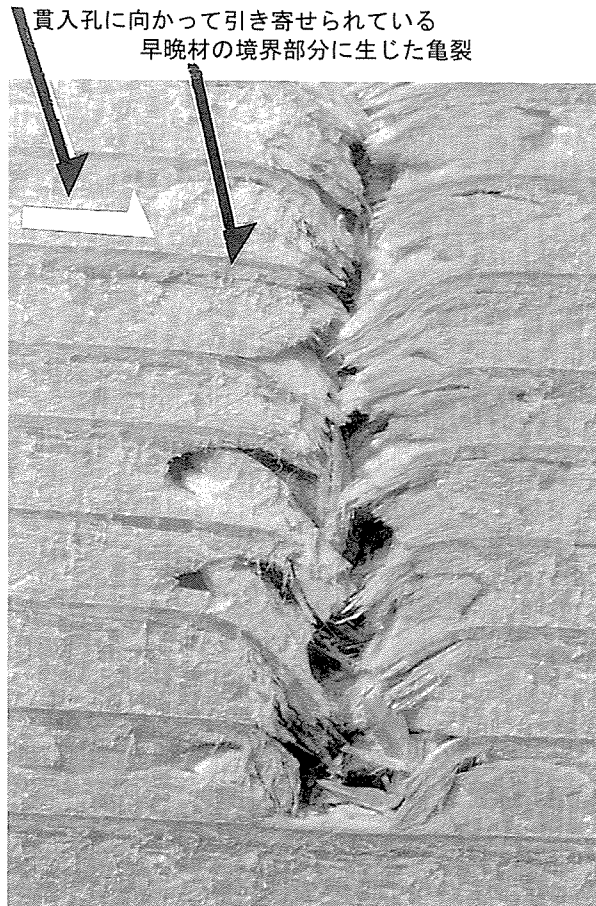
図12 スギ柱目面における木材組織の破壊形態
