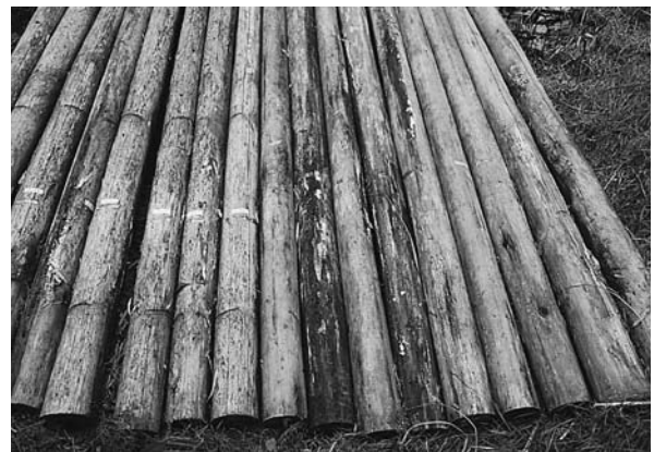
図4 腐朽の進行した丸太
