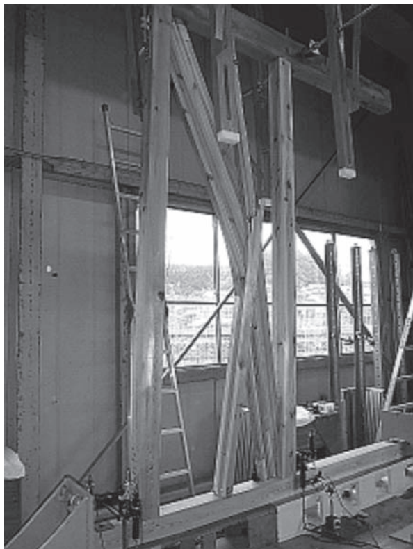
図6 半間幅 試験体の破壊 注：圧縮筋かい方向 (SH2)
