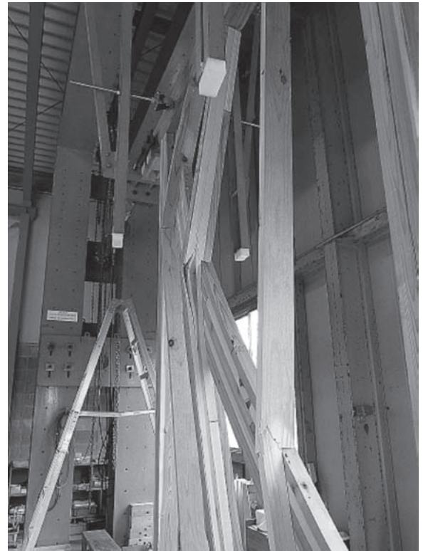
図10 1間幅試験体の破壊(3) 注:引張筋かい方向(S3)
