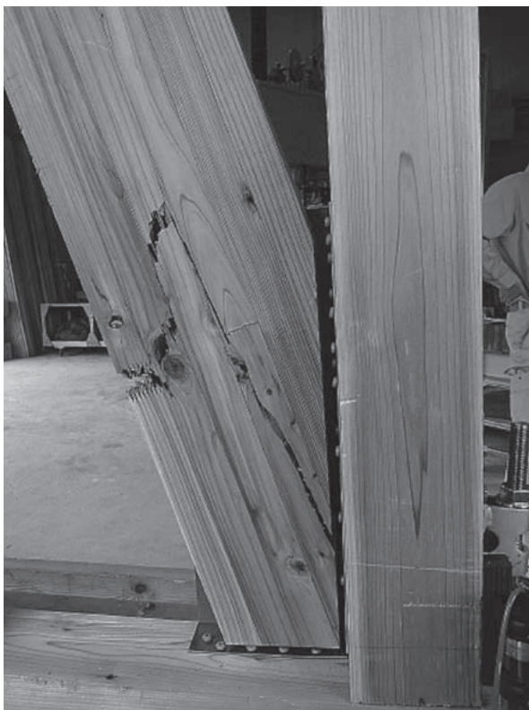
図5 半間幅試験体の破壊
