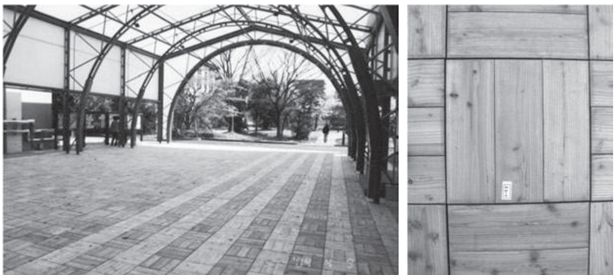
図3 グリオキザール樹脂処理スギ・ヒノキ・カラマツ材を用いた奈良女子大学国際交流プラザの木製舗道材
