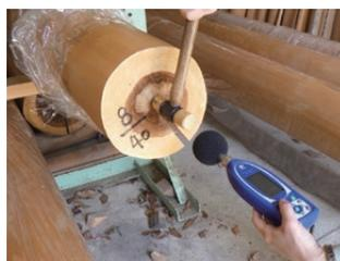
図2 固有振動数測定
