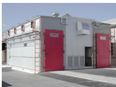
写真 蒸気高周波複合乾燥機 (奈良県御所市)
