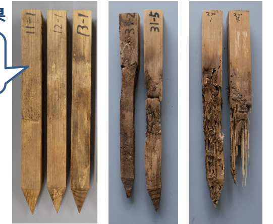
スギ黒心材 被害小 スギ辺材 被害大 スプルース 被害大
