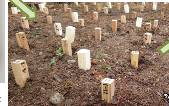
イエシロアリ生息地に埋設(約10ヵ月間)
