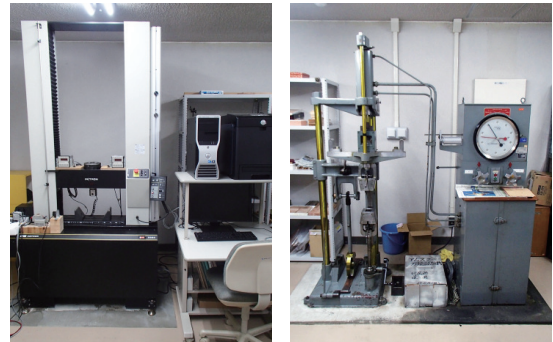
図1 小試験体用の材料試験機
