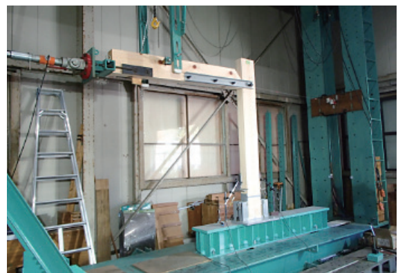
図4 面内せん断試験機による接合部の試験
