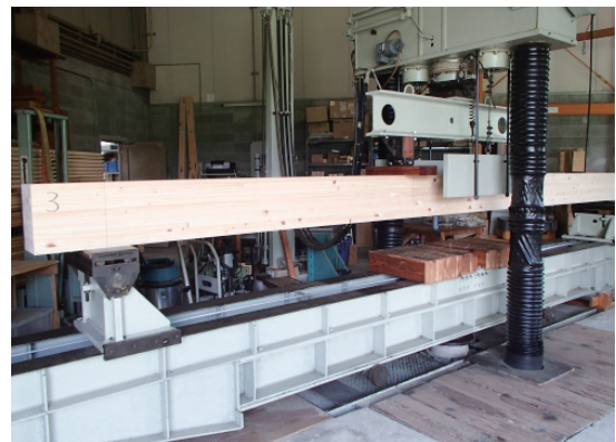
図2 実大試験機を使用した曲げ試験
