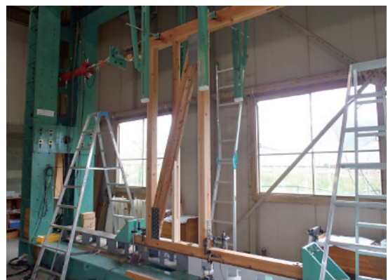
図3 耐力壁の面内せん断試験
