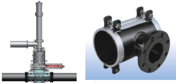
不断水分岐工法（左図）及び割 T 字管（右図）
