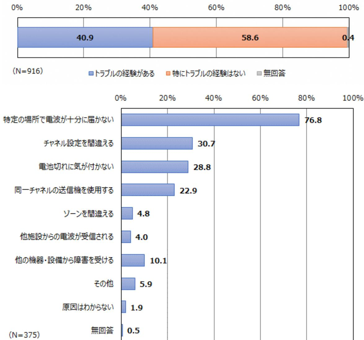
図 19 医用テレメータのトラブルの経験とトラブルの原因
