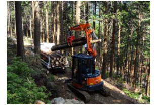
車両による集材に適した奈良型作業道
