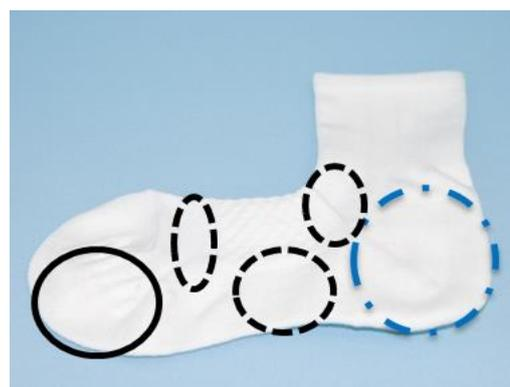
図 5 試料ソックス 2-1：実線部分は滑りにくい編地、点線部分はメッシュ編地、一点破線部分(かかと部分)はパイル編地
