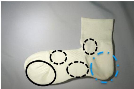
図 7 試料ソックス 3-1：実線部分は滑りにくい編地，点線部分はメッシュ編地，一点破線はパイル編地
