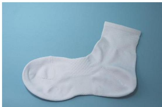
図 4 試料ソックス 1-4：平編みのブランク
