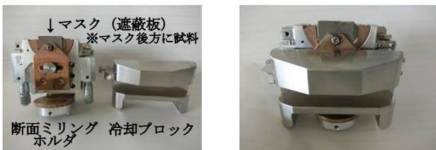
図4 冷却ブロックを搭載した断面ミリングホルダ
