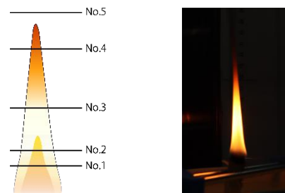
図 1 煤の採取箇所と実験中の炎の様子
