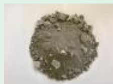
RC-40(コンクリート) (コンクリート塊)
