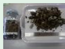
RC-40 (コンクリート塊・アスファルト塊)
