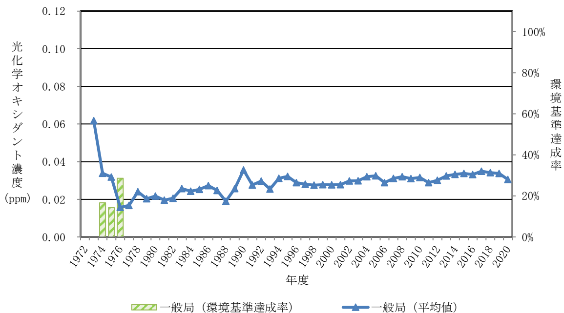
図3. 光化学オキシダント経年変化（昼間の1時間値の年平均値）
