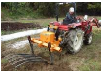
デガー(振動掘り取り機)による掘り上げ
