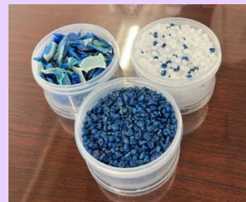
▲リングスター奈良事業所(生駒市) (上)、粉碎・ペレット化した海洋プラスチックごみと海洋プラスチックごみ10%配合の製品原料(下)
