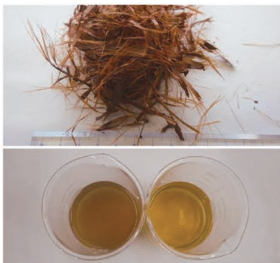
スギ樹皮(上)とそれを抽出した染色液(下) (詳しくは4～5ページ)
