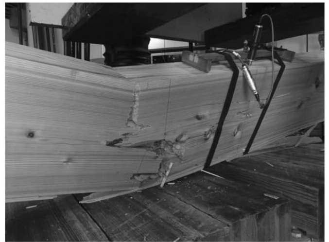
(a) D 試験体の破壊
