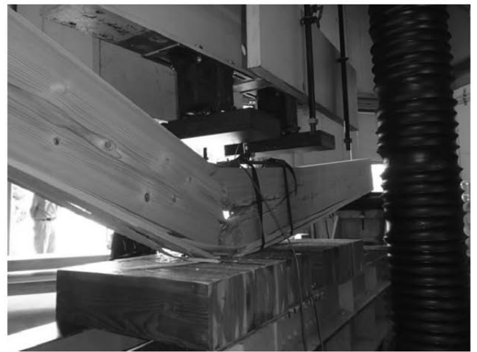
(a) D 試験体の破壊
