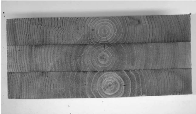
図7 減圧加圧剥離試験後の試験片 (C試験体)
