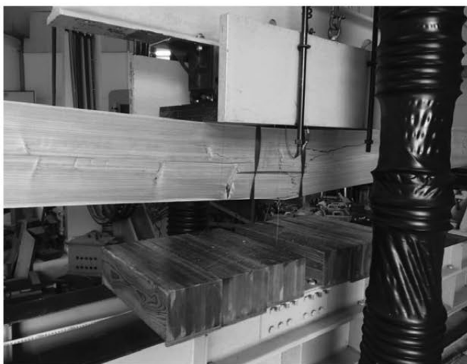
(c) C試験体の破壊
