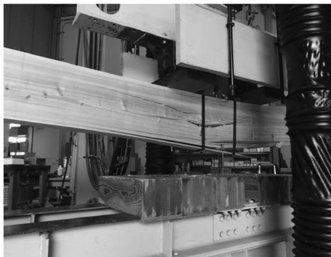
(b) B試験体の破壊
