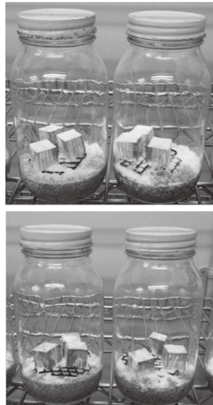
図5 カワラタケによる腐朽操作終了時の様子 上：キハダC辺材 下：キハダC心材
