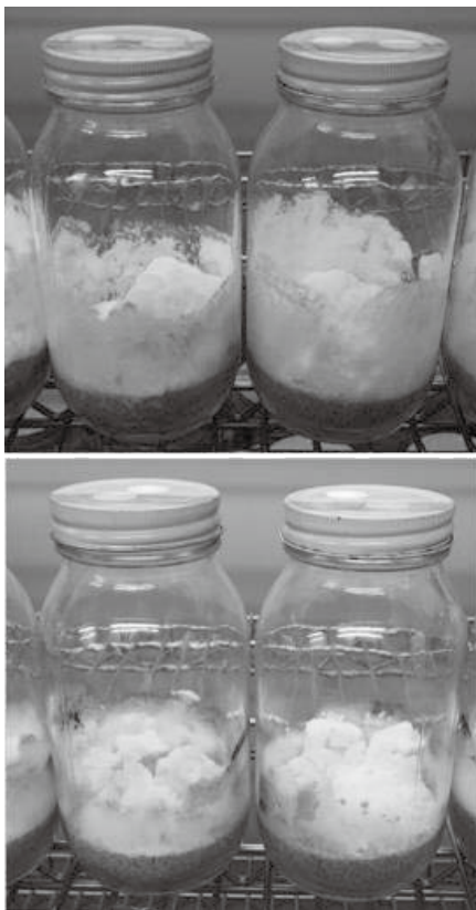
図4 オオウズラタケによる腐朽操作終了時の様子 上：キハダC辺材 下：キハダC心材
