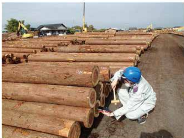
丸太をハンマーで叩くと強度が推定できる？ (奈良の木ブランド課と共同の取り組み) (詳しくは2～3ページ)
