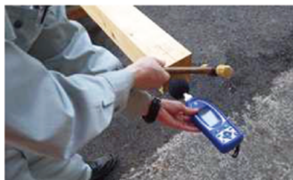
図4 縦振動法による測定の様子
