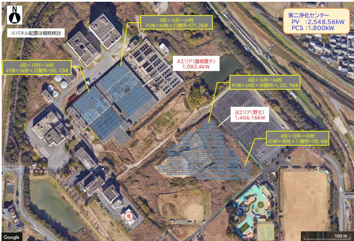
図 4-37 パネル配置図(第二浄化センター)
