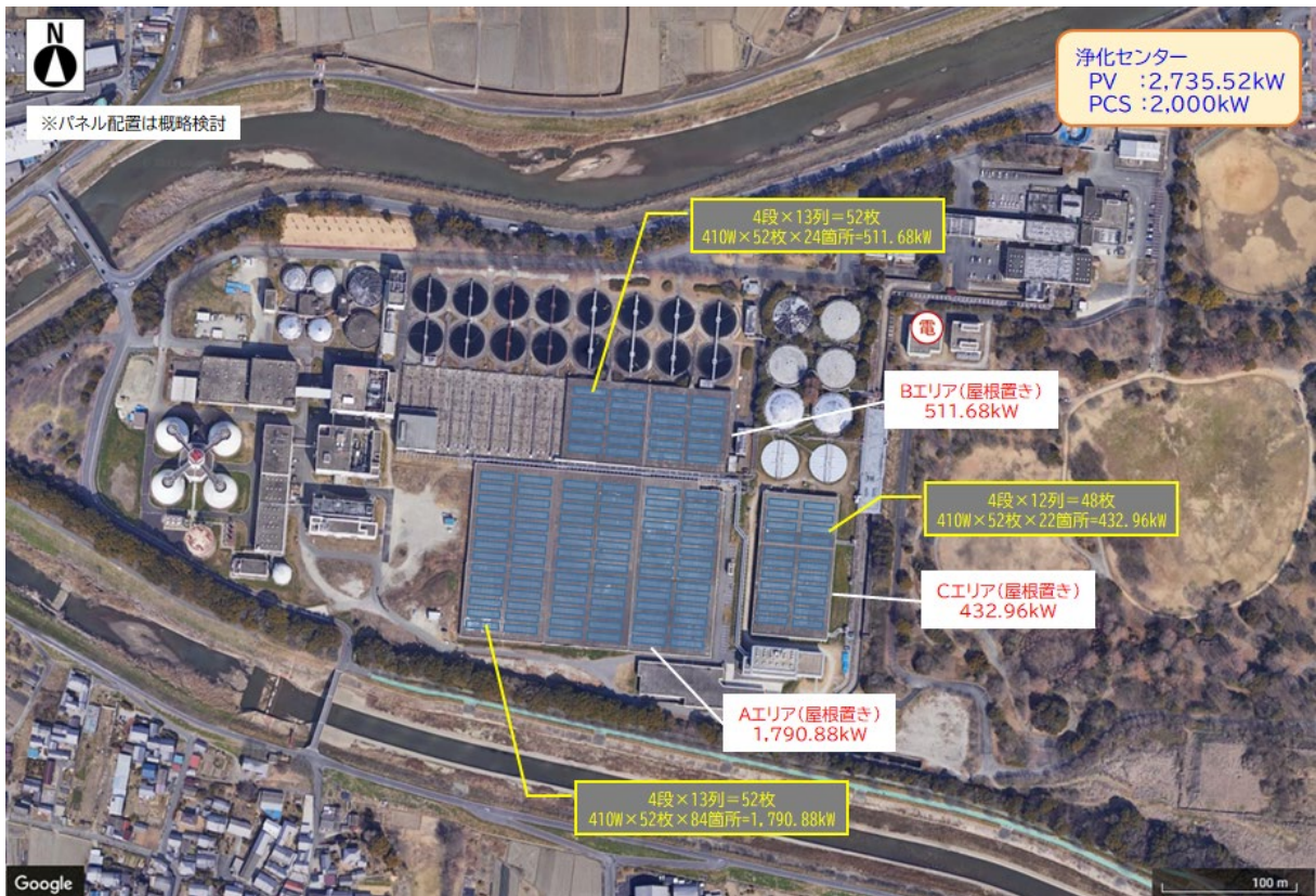
図 4-36 パネル配置図(浄化センター)
