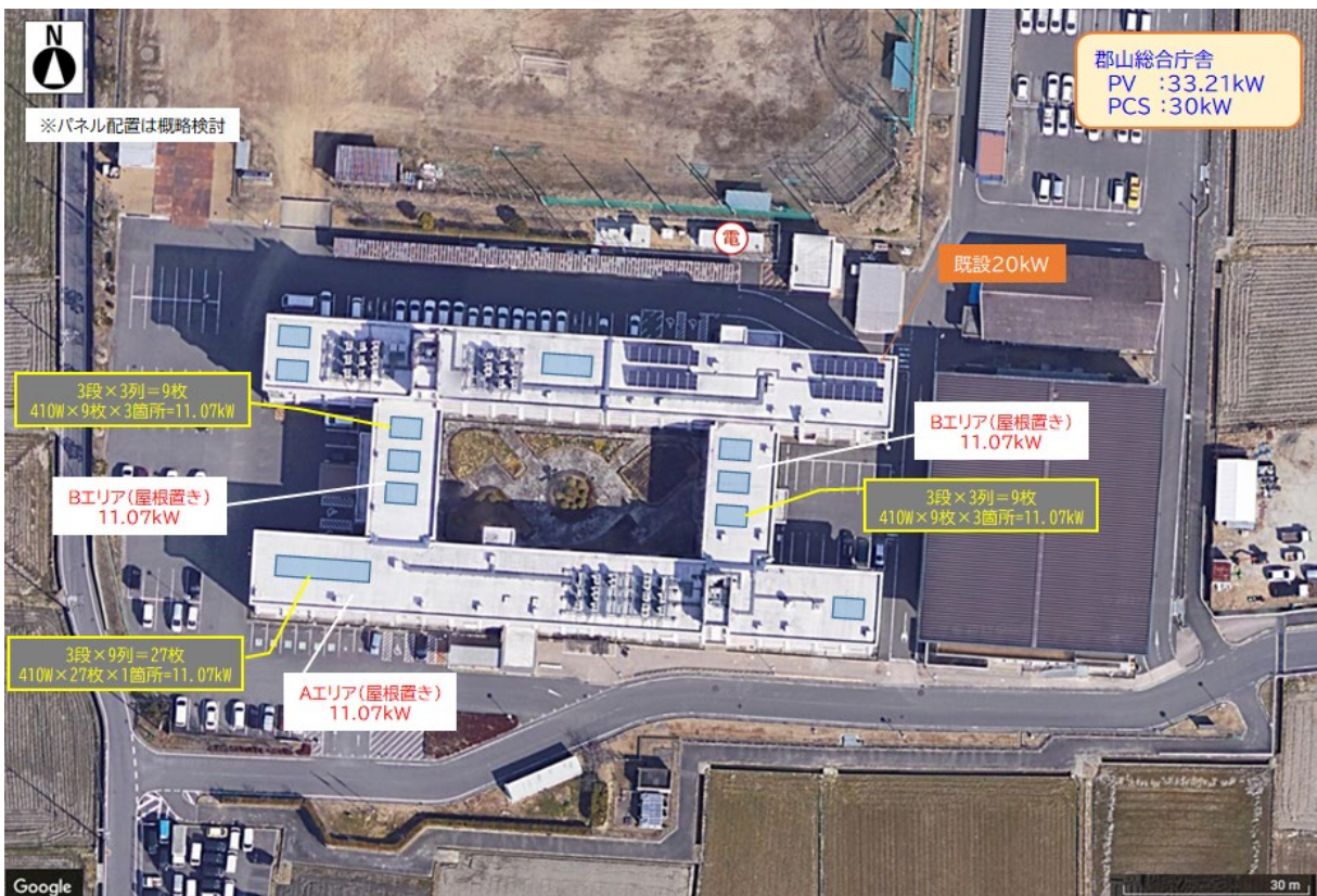
図 4-35 パネル配置図(郡山総合庁舎)
