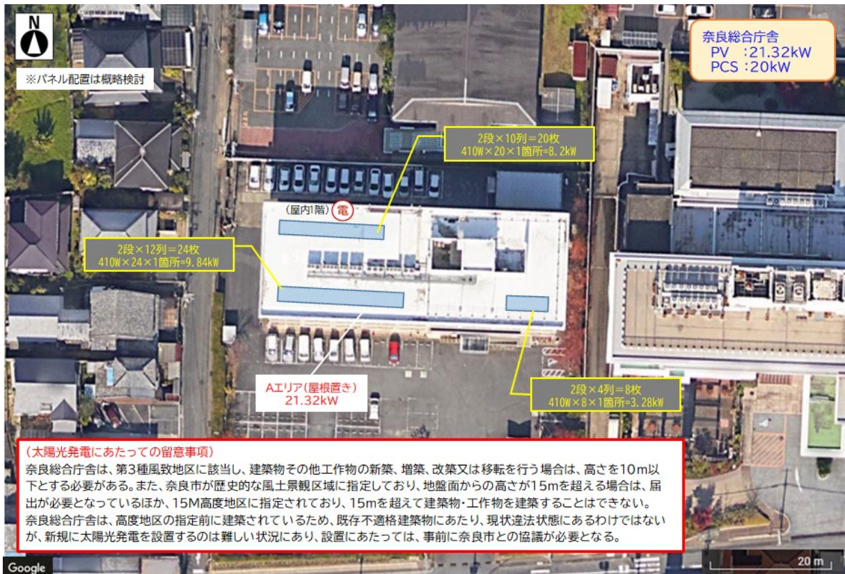
図 4-34 パネル配置図(奈良総合庁舎)
