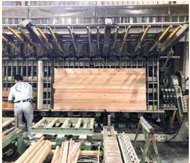
■吉野の製材所にてはぎ合わせをします。
