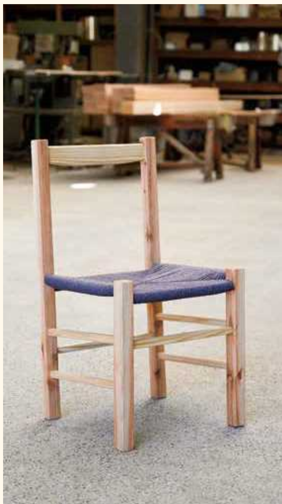
■直径20センチの小径木の丸太から作られた椅子
